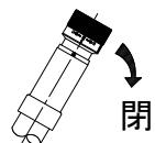
ノズル先端部を、時計方向（“閉”の表示方向）に、ストップバーへ
