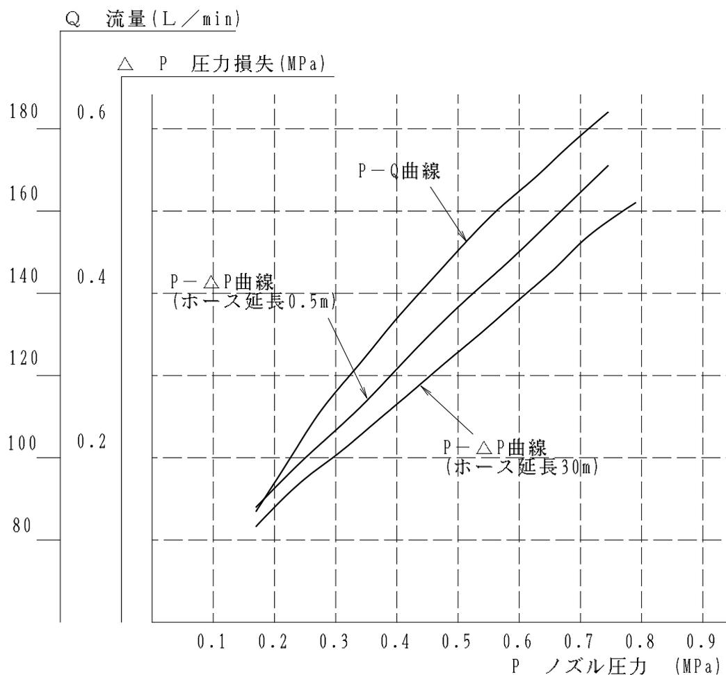
圧力損失 (水量 80 L/min 時) 最大値 0.14MPa
